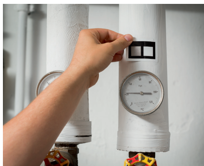
Umieść testo \epsilon - marker i zrób zdjęcie obiektu za pomocą aparatu cyfrowego w kamerze
